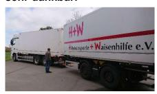
Mit dieser finanziellen Hilfe war es nun möglich, eine gebrauchte Lafette und einen gebrauchten Koffer zu kaufen. Da unser Lkw für Wechselbrücken ausgerüstet ist, können die beiden Koffer getauscht werden. was ein großer Vorteil ist. wenn Abladestellen nicht mit dem Anhänger, sondern nur mit dem Motorwagen angefahren werden können.
